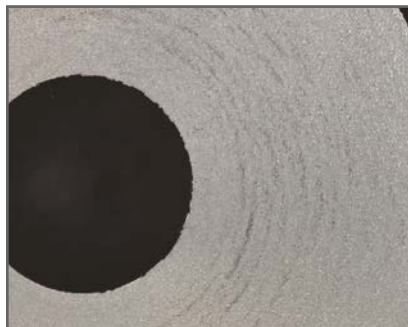
úhel břitu 6° – Rz 11.3 μm
