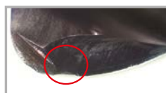
Poškození kvůli vysokému zatížení
